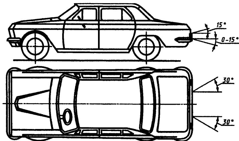
6.4.5. Должна обеспечиваться возможность прочтения заднего государственного регистрационного знака с расстояния не менее 20 м в темное время суток при условии его освещения штатными фонарями, предусмотренными конструкцией транспортного средства для этой цели.
