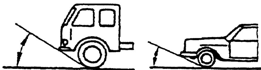
Рисунок 2. Угол съезда
